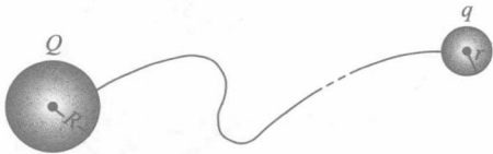
图 7-40 论证带电导体上的电荷面密度与曲率的关系
