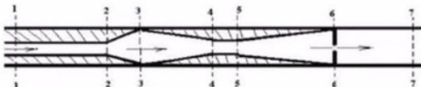
管中非均匀截面的流段可能出现回流的有 2-3、5-6 流段；不会出现回流的有 1-2；
