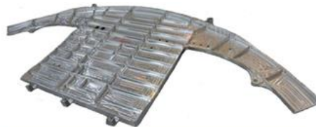
尺寸：2.8m×2.3m；最薄壁厚：0.4mm
