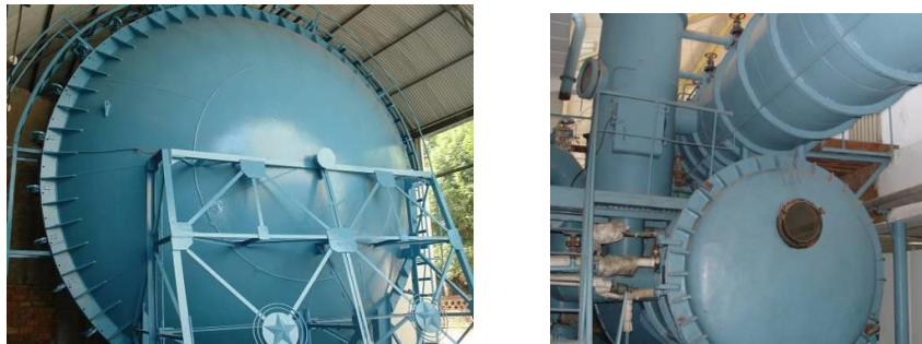
图 5.12 南京航空航天大学高空环境模拟舱
