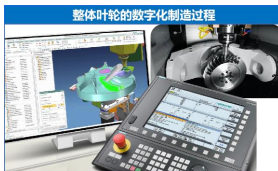
图 3.14 整体叶轮的计算机辅助制造过程
