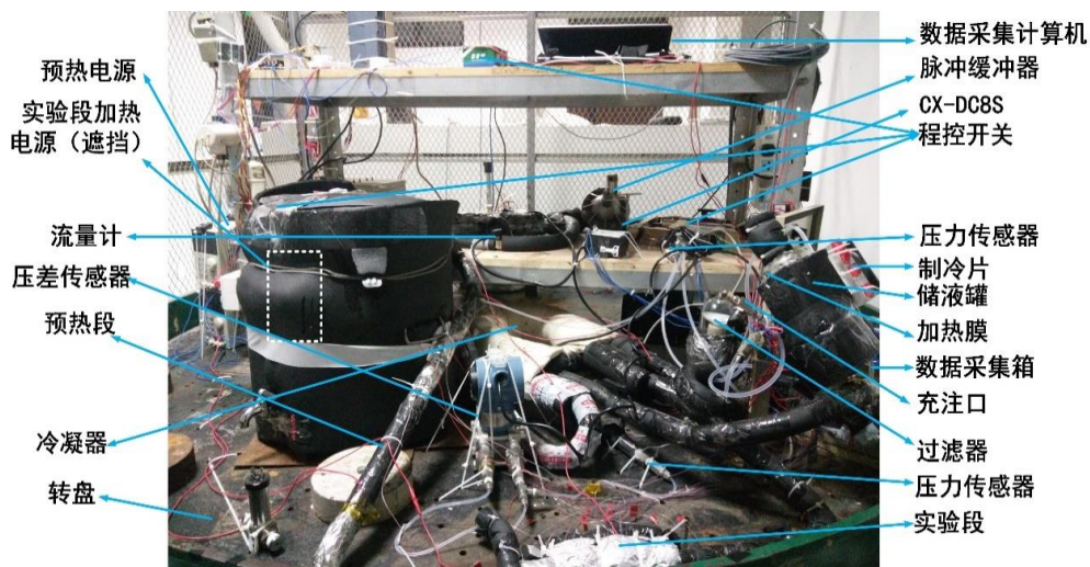
图 5.15 南京航空航天大学两相流过载实验台旋转平台上设备实物图
