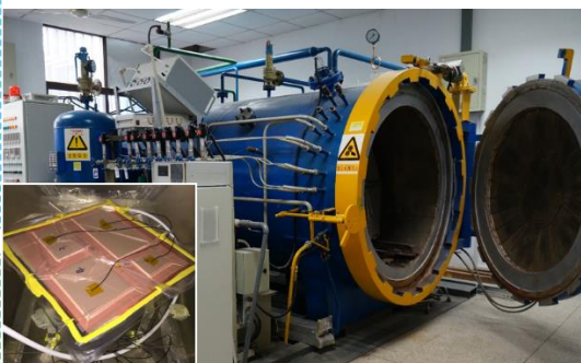
图 3.38 南航自主研发的微波高压固化装备
