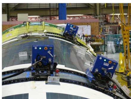
(a)美国 EI 公司的柔性轨道制孔系统
