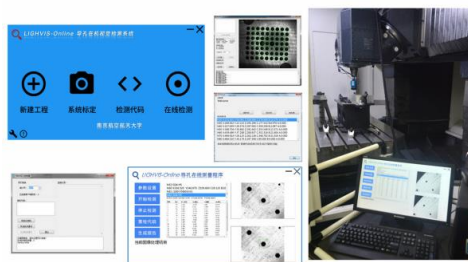
图 3.31 飞机零件导孔在机快速视觉检测系统
