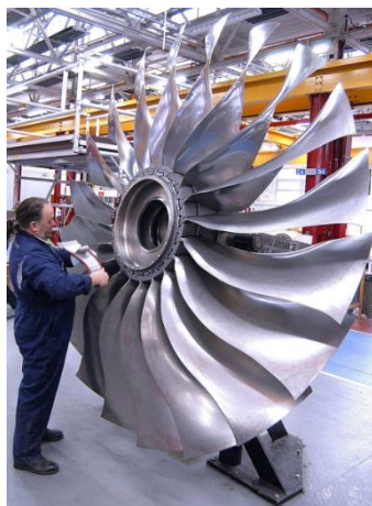
图 4.36 Trent1000 采用的空心宽弦叶片
