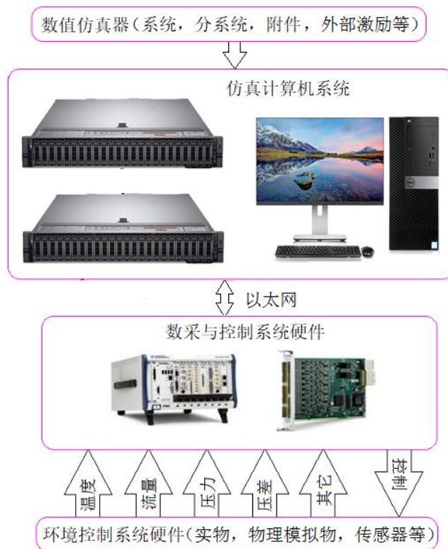
图 5.17 环境控制系统半物理仿真实验台示意图
