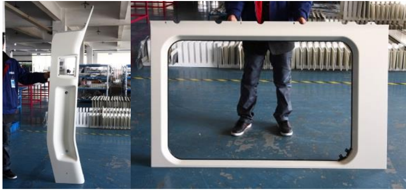
图 3.20 地铁立柱及门框超塑成形件
