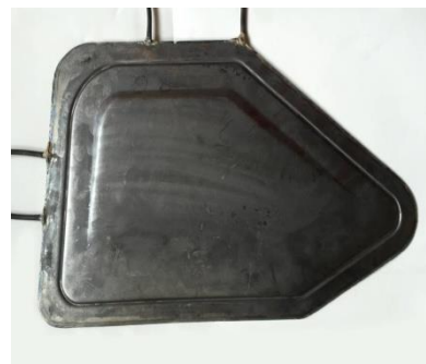
(b) 含预置块的钛合金 SPF/DB 成形件
