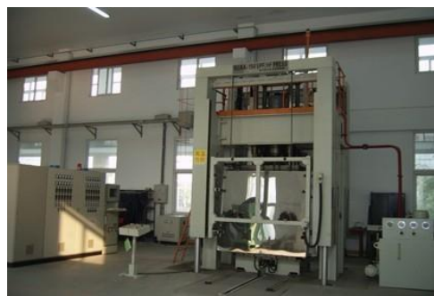
图 3.18 自主研发的超塑性热成形机床及其加载系统
